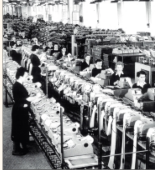
ICO, primi robot di collaudo a banda perforata per macchine da calcolo MC14 e MC 21 (1955/56 Ivrea)
